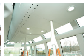
TOYOTA IMTSの車内LED天井照明
