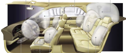
ニーエアバッグ シートクッションエアバッグ サイドエアバッグ 後席センターエアバッグ
