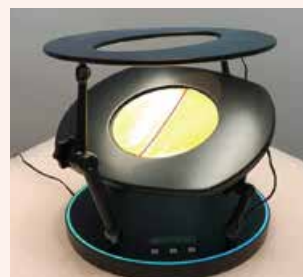
冠動脈バイパス手術のトレーニングをするためのシミュレータ「SupeR BEAT」。電気のオン/オフに速やかに反応して伸縮するe-Rubberを用いることで、手術中に生じる不規則な心拍も忠実に再現できる。
