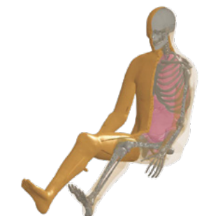
THUMS (仮想人体モデル)を使用した解析 工連携により法規・アセスメントで評価されない受傷部位にも着目 THUMS: Total HUMAN Model for Safety
