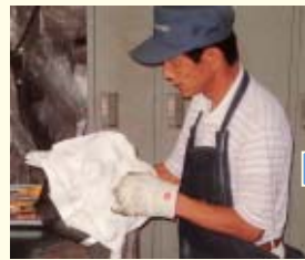
エアバッグの解体作業
