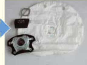
リサイクルしやすいよう解体されたエアバッグ
