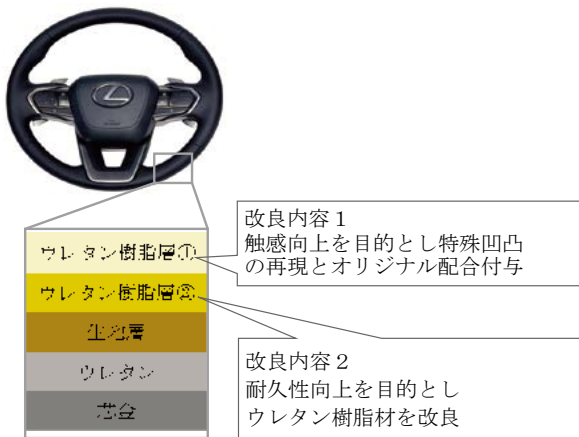
図-6 合皮断面構成と改良内容
