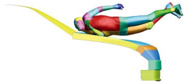
図-3 フード持上げシステム評価 1)
