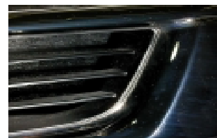
写真—1 部分めっきグリル
