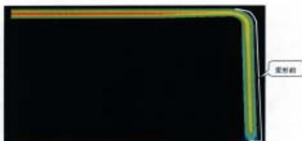
図14. そり解析結果 (変形と応力分布)
