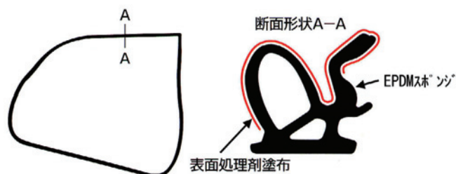
図-2 ドアウェザーストリップ製品の構成 (A-A)
