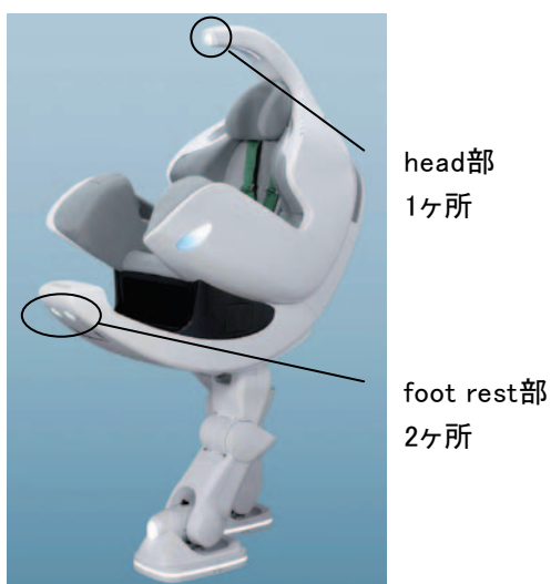
図-4. i-foot外観と照明設置箇所
