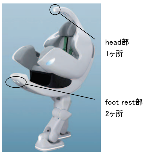
図-4. i-foot外観と照明設置箇所
