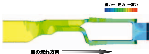
図-7. 後席用ダクト経路内の通風時圧力損失解析結果
