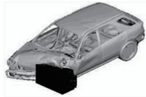
(1) ボディの衝突変形解析事例
