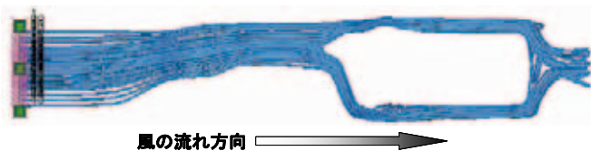
図-8. 後席用ダクト経路内の風流れ解析結果
