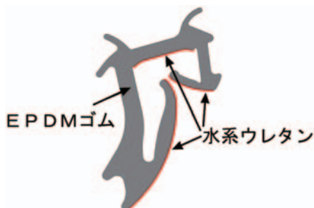
図-2 ガラスラン製品の構成 (A-A)
