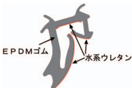
図-2 ガラスラン製品の構成 (A-A)
