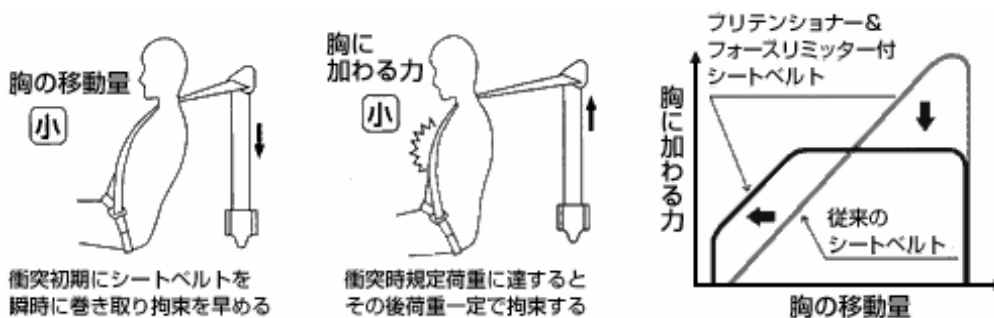
図－4 シートベルトプリテンショナー、フォースリミッター機能 4)
