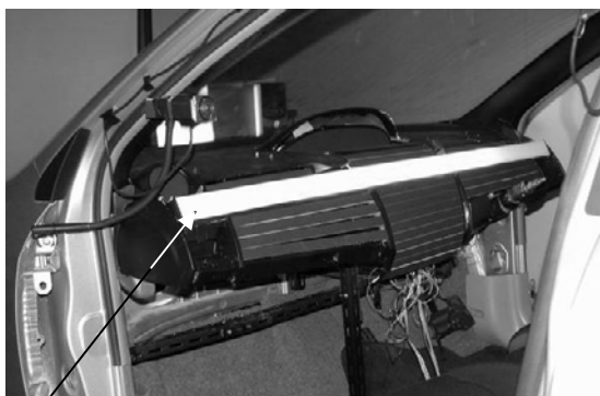
400Hzの音圧レベルに合わせ左右8個ずつ並んだLED(青)が点灯
