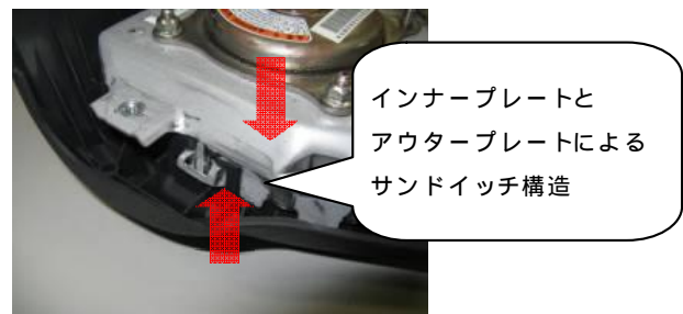
図-3 従来品のパッドカバー締結
