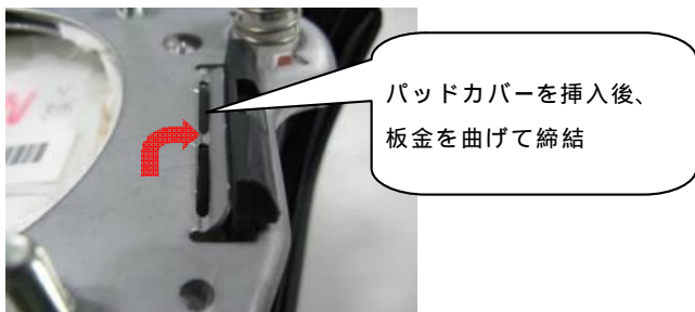
図 - 4 開発品のパッドカバー締結
