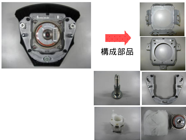
図-1 従来品の構成部品
