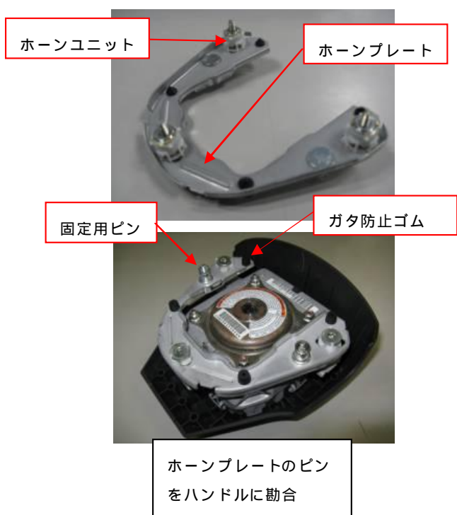
図 - 5 従来品におけるハンドルへの締結方法
