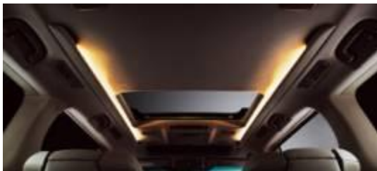
b) 天井間接照明
