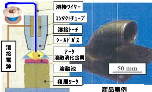
図 3 溶融金属積層法の模式図<sup>4)</sup>
