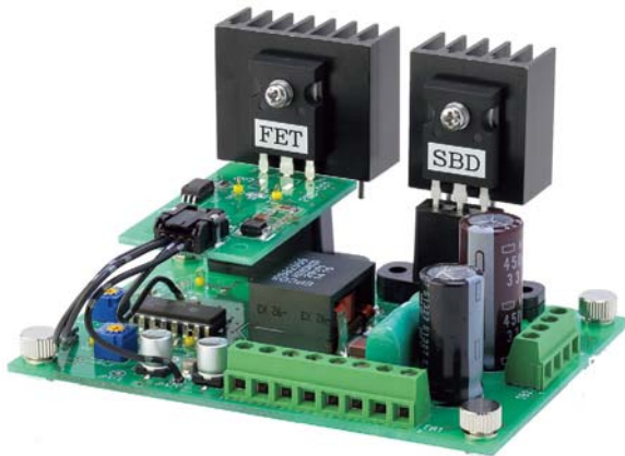
図-10 フル縦 GaN DC-DC コンバータ DC-DC コンバータに縦型 GaN MOSFET と縦型 GaN SBD を同時に搭載したのは、世界初である (2018年4月TG調べ)
