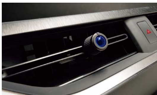
図-2 ワイヤレス給電レジスタノブ照明
