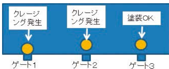
図-15 多点ゲート製品の模式図
