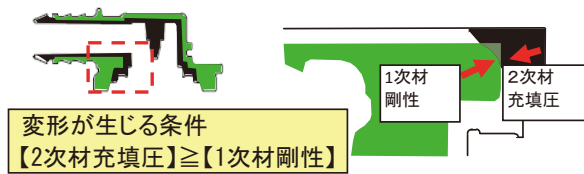
図-5 1次材変形条件
