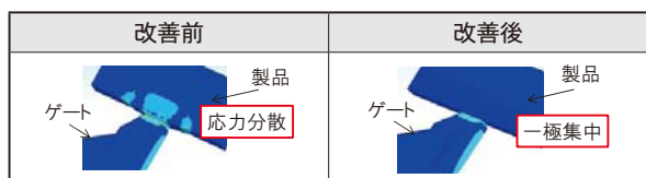
図-7 引張応力分布シュミレーション
