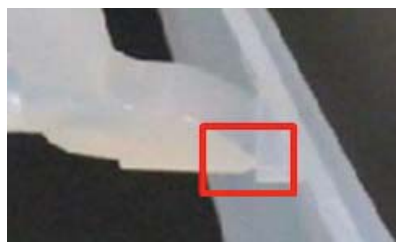
図-6 樹脂成形品ゲート部の拡大
