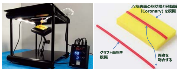
図-3 心拍動冠動脈バイパス手術訓練シミュレータ BEAT (左) 冠動脈モデル YOUCAN (右)
