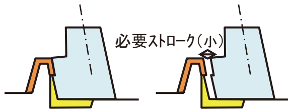
図-6 キャブスライド機構
