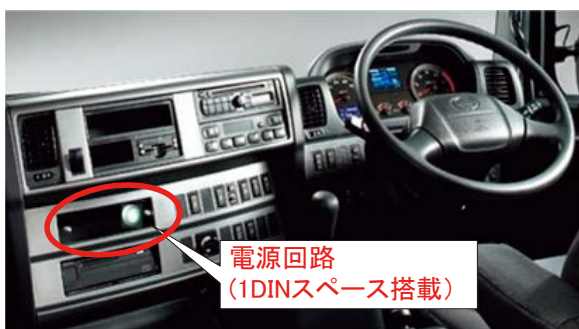
図-3 電源回路搭載状態
