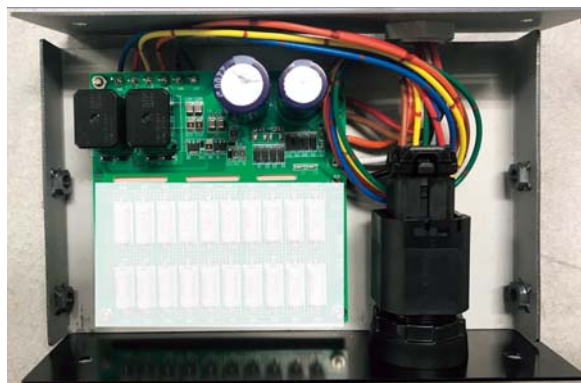
図-5 電源回路内部
