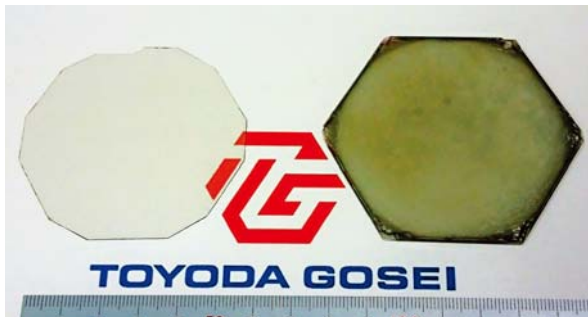
図-1 3インチサファイア基板上にNaフラックス法 (第一世代)で成長後、剥離した自立GaN結晶。(左)研磨後の結晶(右)as grown結晶
