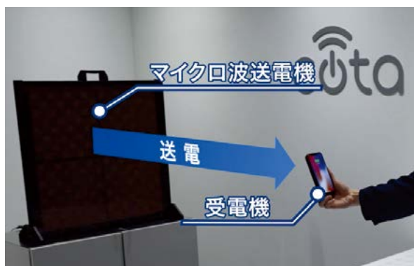
図-6 スマホカバー型受電機の実証
