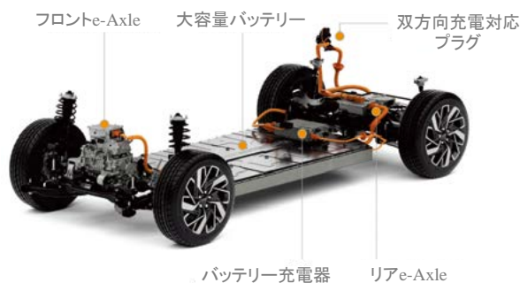
図-5 IONIQ 5 における e-Axle 搭載状態
