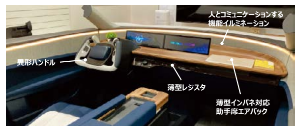
図-5 薄型インパネを実現する技術アイテム事例
