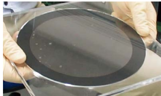
図-1 Na フラックス法で育成した GaN 種結晶
