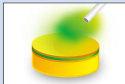
高温のサファイア基板の上に、窒素やガリウムなどのガスを噴きかけて結晶化させる
