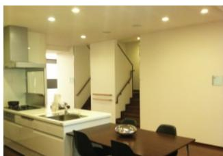
また、個人向けでは、当社従業員宅の新築住宅の照明を全てLEDにする提案をし、モニタリングを兼ねてLED照明を設置しました。家庭用を考慮して交換の容易な電球型とし、明るさも蛍光灯と同等の照度を確保しました。蛍光灯が冬場など低温での立ち上がりが遅いのに対し、LED照明は瞬時に発光して明るさを確保できることから快適に使用できます。また、電球交換のサイクルが長いので、取り替えの煩わしさが低減でき、消費電力も蛍光灯に比べ40%低減できます。
