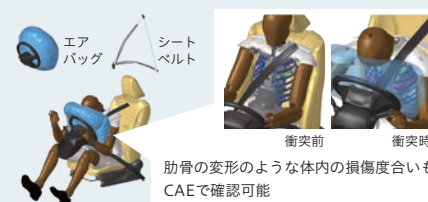
図2. エアバッグとシートベルトのセット開発(CAE)
