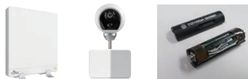
左: OSSIA社と共同開発する送電機 中: 受電機を組み込んだIoT監視カメラの試作機 右: 単三電池型のワイヤレス受電機
