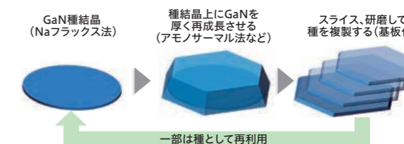
Naフラックス種結晶を利用した大口径GaN基板作製の工程イメージ
