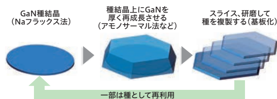
Naフラックス種結晶を利用した大口径GaN基板作製の工程イメージ
