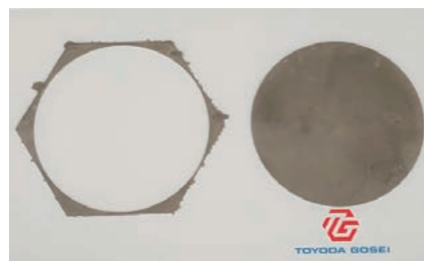
六角形状のNaフラックスGaN結晶をくりぬいて作製した直径6インチ種結晶
