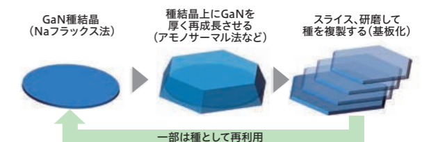
Naフラックス種結晶を利用した大口径GaN基板作製の工程イメージ
