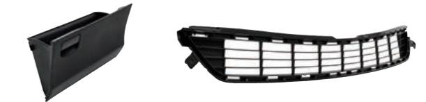
ELVリサイクル原料を活用した製品事例：(左から) グラブボックス、ロアグリル
