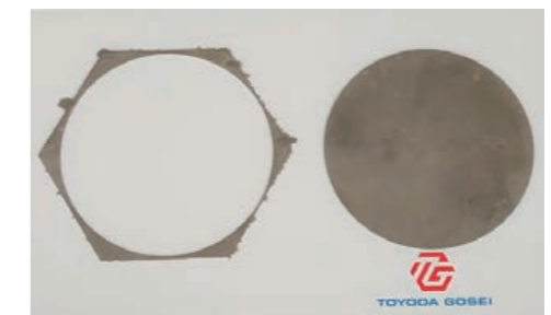
六角形状のNaフラックスGaN結晶をくりぬいて作製した直径6インチ種結晶
