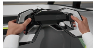
生体検知ステアリング(アルコール検知など)
