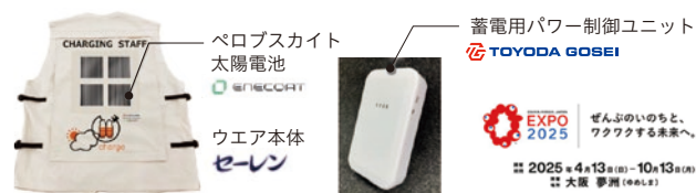
スマートウェア試作品およびパワー制御ユニット
