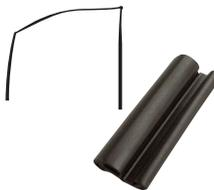
ボディシーリング事業部は、騒音や雨、風、ホコリを防ぐウェザーストリップ等を開発しており、この分野でも環境負荷の少ない製品開発を行っています。今回開発したガラスランは、従来あった基底部の植毛にかわって、ゴム加硫後の余熱でPE（ポリエチレン）シートを貼り付けたものです。植毛接着のための熱処理が不要になったことにより、エネルギー量を削減しました。
