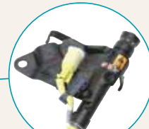
ポップアップフードアクチュエータ 歩行者頭部保護装置
