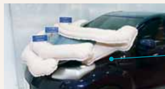
歩行者保護エアバッグ(開発中) 前面衝突時に展開し、歩行者を保護するエアバッグ
