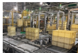
RFIDを使用した通箱の 自動仕分け・流通トラッキング
