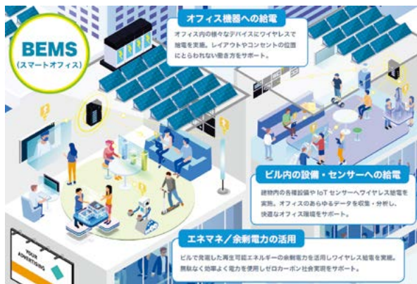
図-2 マイクロ波給電とスマートオフィス
