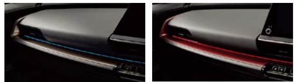
図-3 LED 通知イルミネーション仕様 (左:ブルー発光仕様,右:レッド発光仕様)
