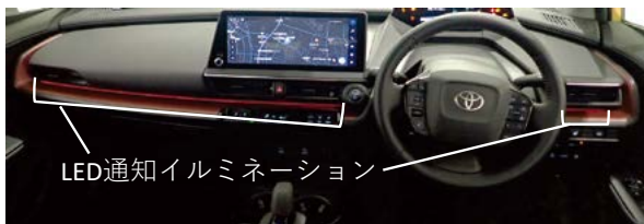
図-1 LED 通知イルミネーション搭載状態
