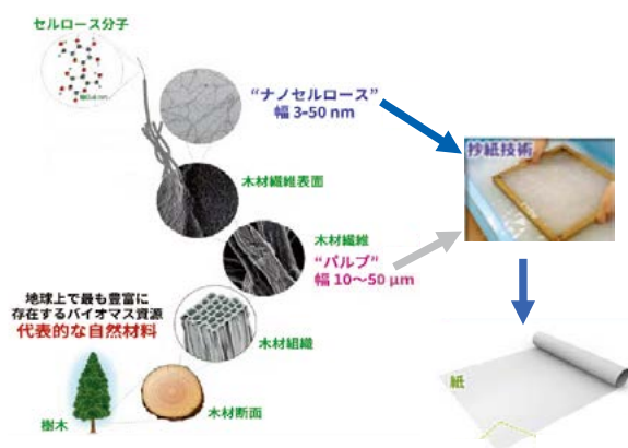
図-9 CNF とパルプの併用 5)
