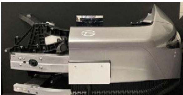
図－4 骨格樹脂化とモジュール化によるシームレス意匠の実現
