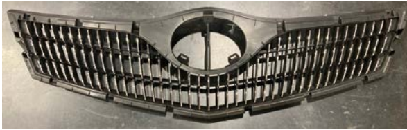
図－10 ホットスタンプ検討用大型成形品
