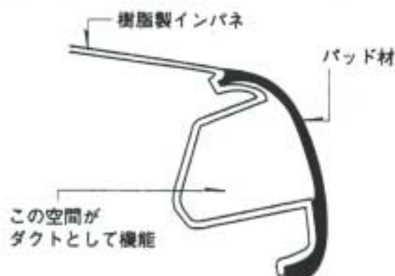
図-16 ダクト一体インパネの断面
