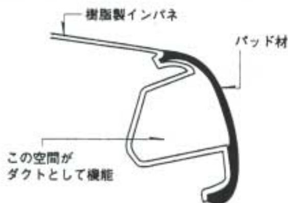
図-16 ダクト一体インパネの断面
