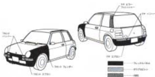
図-9 日産Be-1の主な樹脂製ボディパネル
