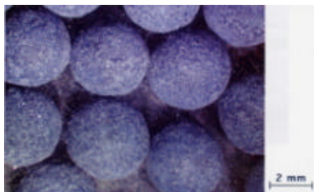
図 8 活性炭混合光触媒外観
