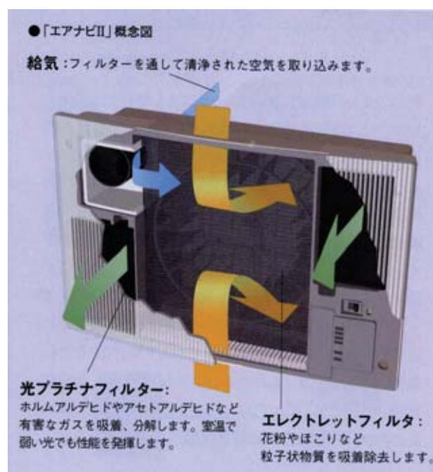
図-2 空気清浄機能概念図
