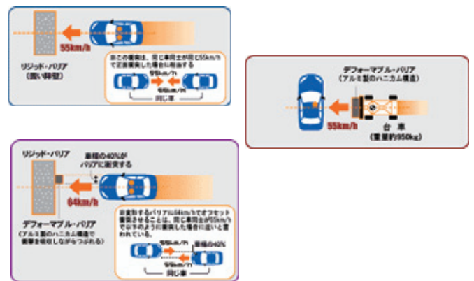
図-2 安全性能アセスメント試験法 2)
