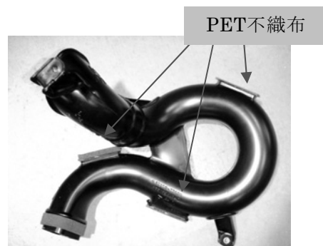
図-2 圧力損失向上無反射ダクト
