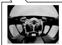
図-5 簡素化締結 (組付けのネジレス化)
