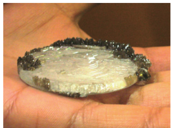
図11. 大型GaN育成装置により育成された3ミリ厚の2インチGaN結晶
