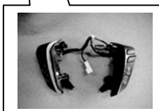
図-4 開発多機能スイッチ (大型化)
