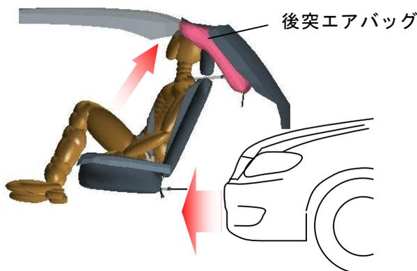
図-3 後突エアバッグによる頭部保護
