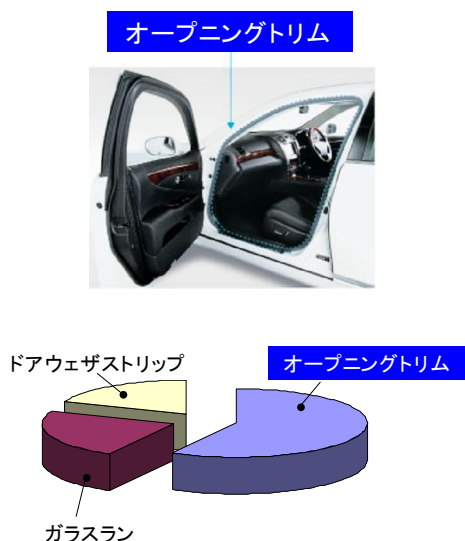
図-1 主要ボディシール部品の 車両1台当りの重量比率
